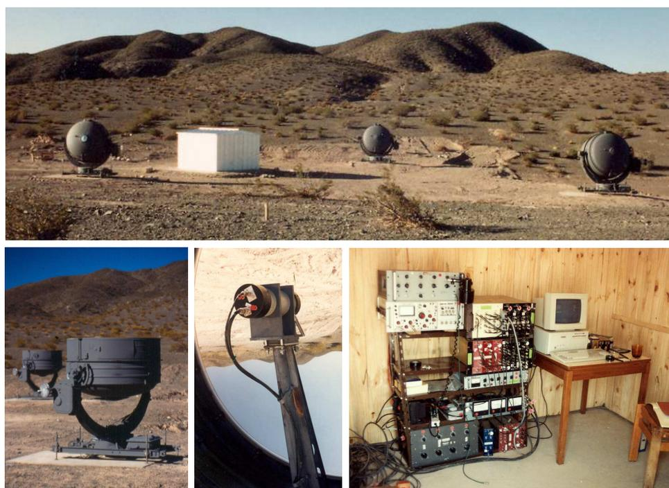
Figura 18 Sistema GAMAR-1 terminado, marzo de 1994. *Arriba:* Vista general en posición de reposo. *Abajo izquierda:* En posición normal de operación. *Abajo centro:* Habitación del detector (fotomultiplicadora) y espejo. *Abajo derecha:* Sala de control con sistema de *trigger* y adquisición.
