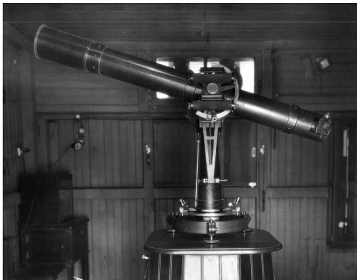
Figura 9 Telescopio Zenital de Wanschaff. Es un altazimut utilizado para las observaciones de latitud, construido por la casa Carl Zeiss de Jena.
