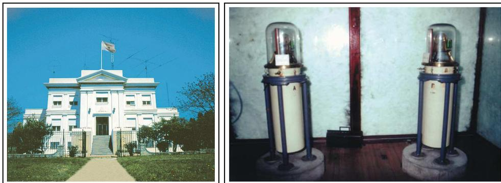
Figura 2 *Izquierda:* Edificio del Observatorio Naval Buenos Aires, desde 1947. *Derecha:* Péndulos de precisión a marcha de tiempo sidéreo y medio procedentes de Casa L. Leroy, Francia, 1926-1971 .
