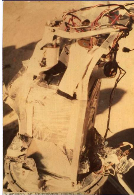
Figura 10 Estado de la carga útil después de un vuelo. Este experimento en particular corresponde a detección de neutrones.
