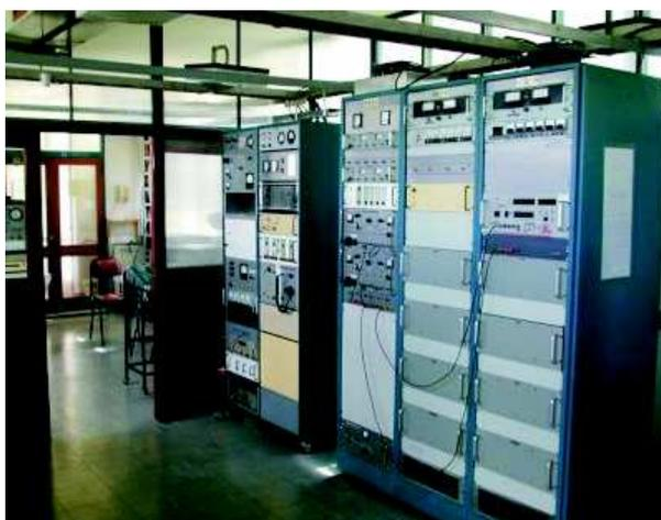
Figura 44 Autocorrelador Digital de 1008 canales.
