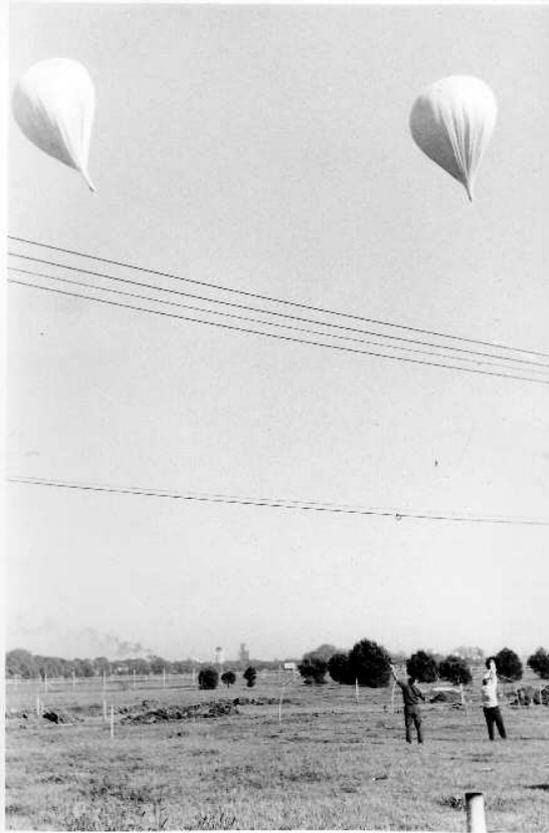
Figura 9 Globos de menor tamaño lanzados para guiar inicialmente la burbuja.
